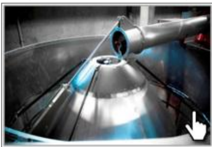
Центральный шнек из стали Hardox
