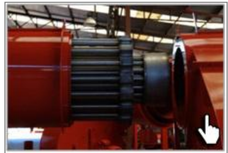
Топочный блок из трех видов легированной стали
