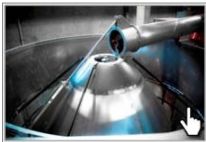
Центральный шнек из стали Hardox
