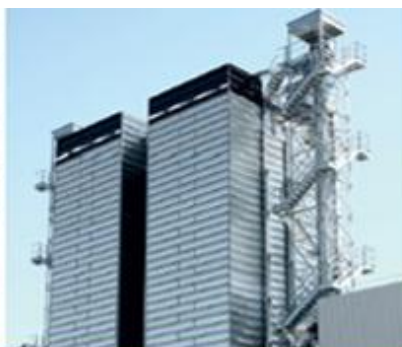
Полностью теплоизо- лированная шахта
