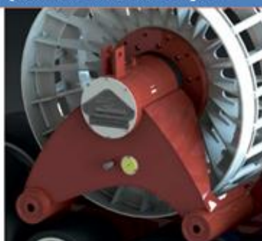
3-точечная навеска обеспечивает установку и демонтаж гусениц за 1-3 часа
