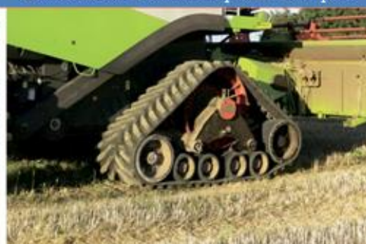
Азотный гидронатяжитель с амортизатором SHOCK ABSORBER обеспечивает автоматическое натяжение резинового трака
