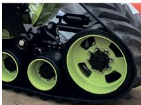
Прорезиненные ролики и натяжители
