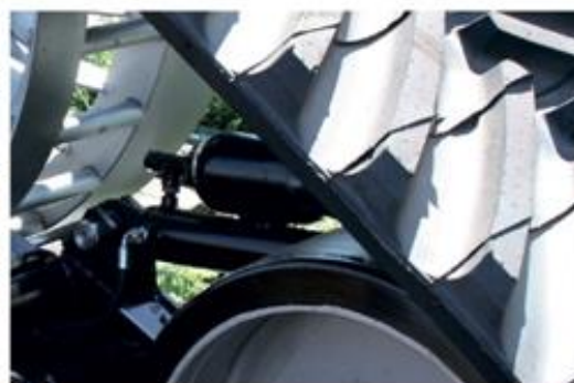
Азотный гидронатяжитель с амортизатором SHOCK ABSORBER обеспечивает автоматическое натяжение резинового трака
