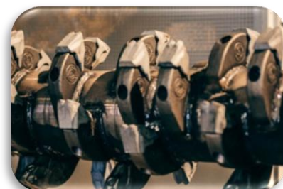
Быстросъемные режущий ор- ган из карбида вольфрама
