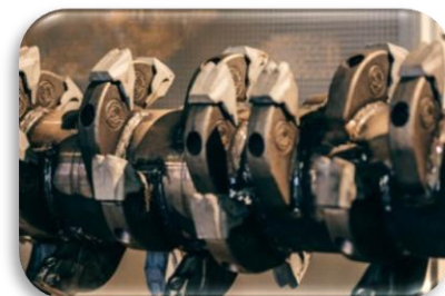
Быстросъемные режущий ор- ган из карбида вольфрама
