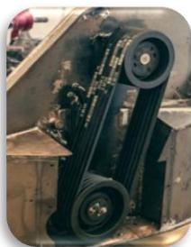
Высокоэффективная двухсто- ронняя ременная передача
