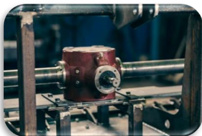
Редуктор с приводом от 1000 об/мин
