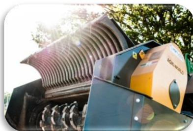
Задняя решетка с гидравличе- ским приводом из HARDOX
