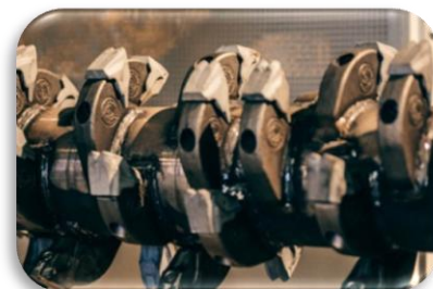
Быстросъемные режущий ор- ган из карбида вольфрама
