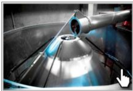
Центральный шнек из стали Hardox
